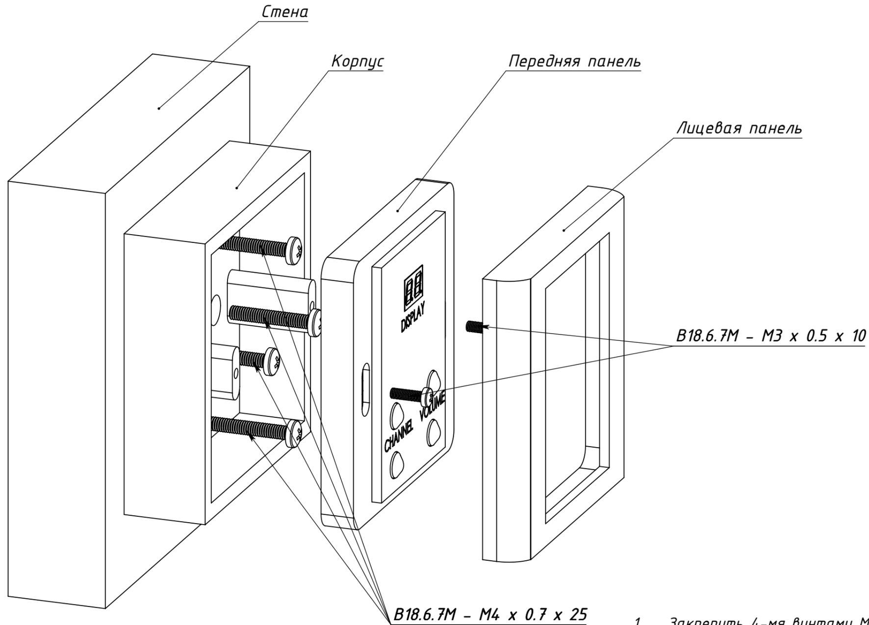
1. Закрепить 4-мя винтами M4x25 Основной корпус к Стене.
